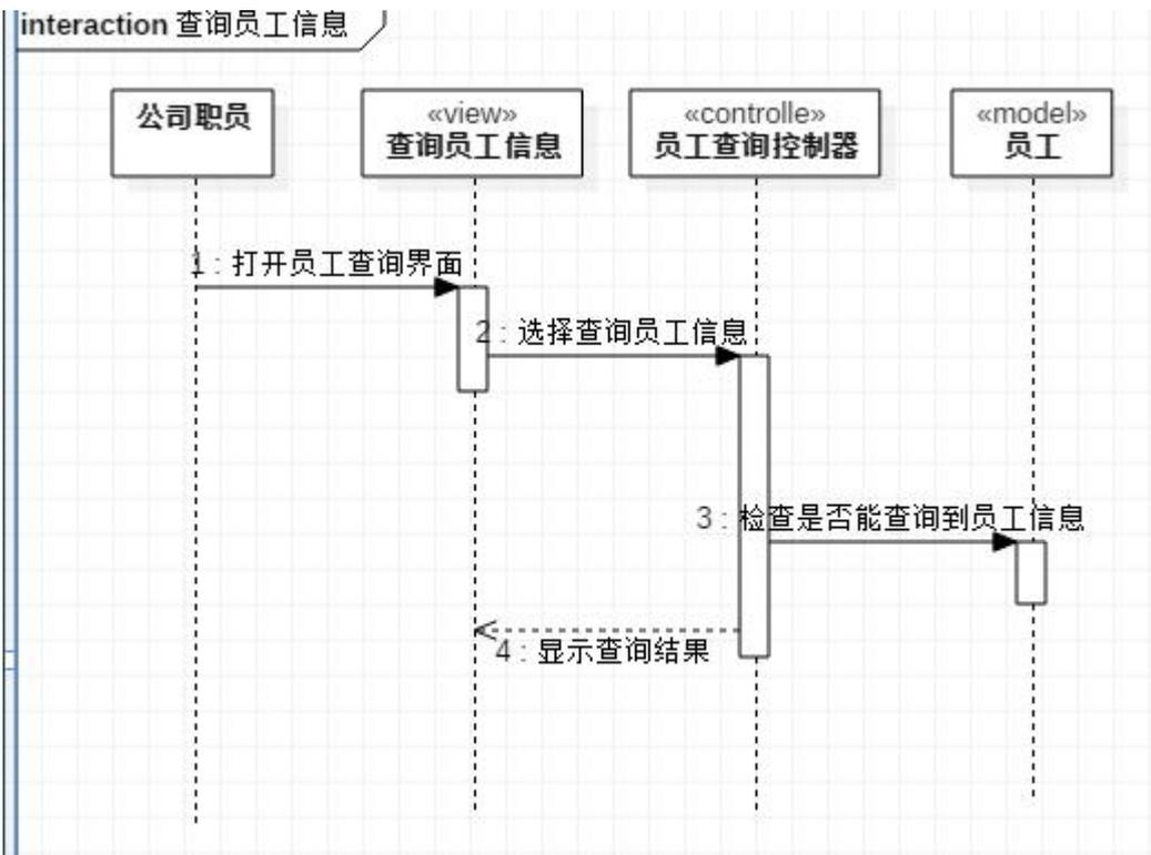
图 7 查询员工信息顺序图
